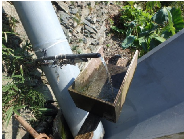
図 5.8：サル追い装置の水を受ける動力部分（筆者撮影）
