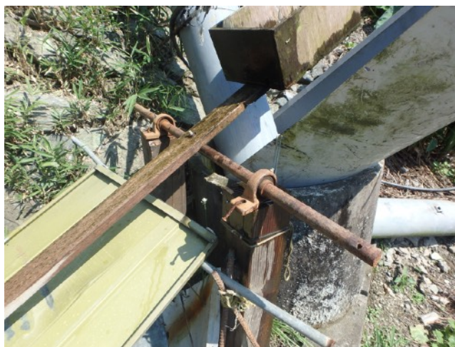
図 5.6：サル追い装置の軸部分（筆者撮影）
