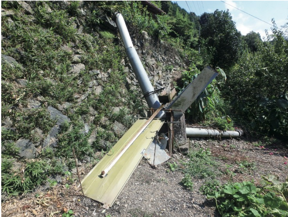
図 5.5：水力駆動の騒音発生型「サル追い装置」（筆者撮影）
