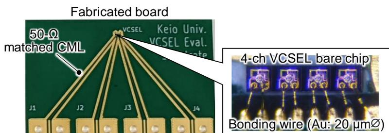
Fig. 4-6 VCSEL 光学特性用評価基板
