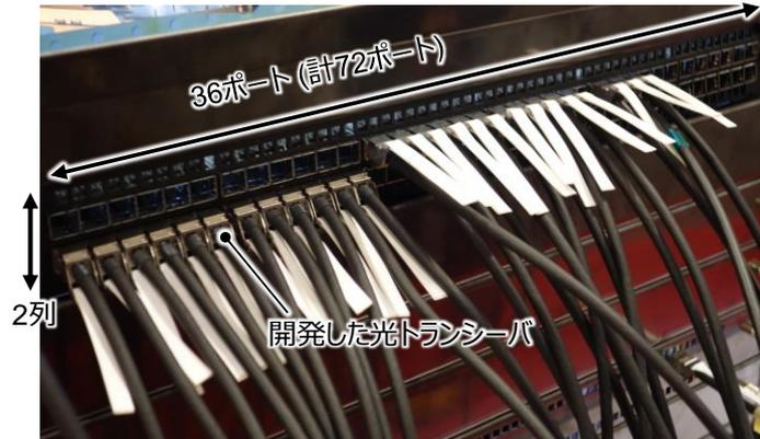
Fig. 3-22 超小型光トランシーバの 19 インチラックサーバへの適用例
