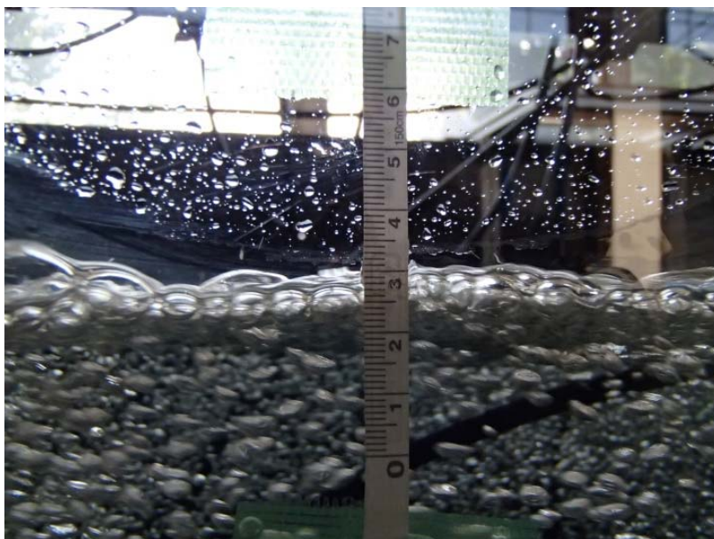
Fig. 3-6 写真による液位の測定
