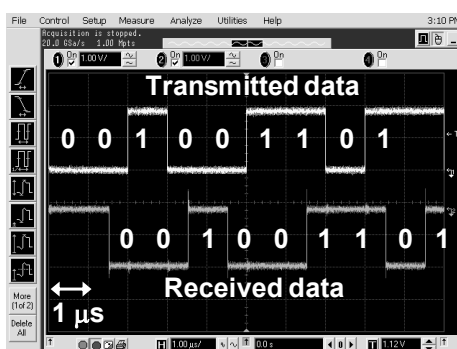
図 2.13 測定した送受信データ(データレート 1 Mbps)[13]
