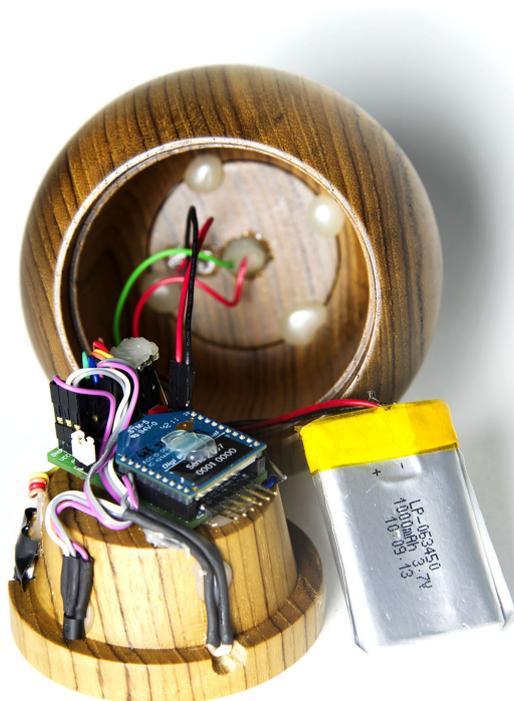
図 4.3: キャンドルホルダーの内部基板 [基板 (2)]
