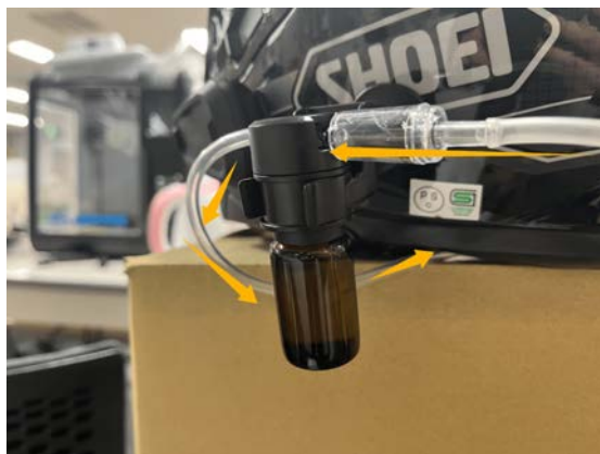
図 3.22 香りの運搬メカニズム
