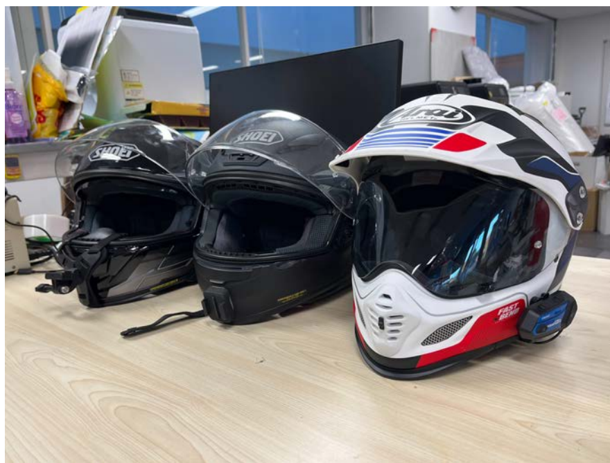
図 4.1 実験に使用した3つのヘルメット（左から順に、トラベル用ヘルメット、競技用ヘルメット、オフロード用ヘルメット）
