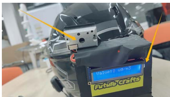
図 3.6 本研究において使用されたシャープ社製の「GP2Y1010AU0F」空気品質センサー
