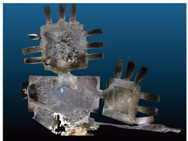
⑥ 3Dモデルをスライスし、平面図・断面図のための画像を作成
