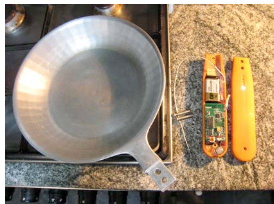
図 2：センサー内蔵フライパンの内部構造
