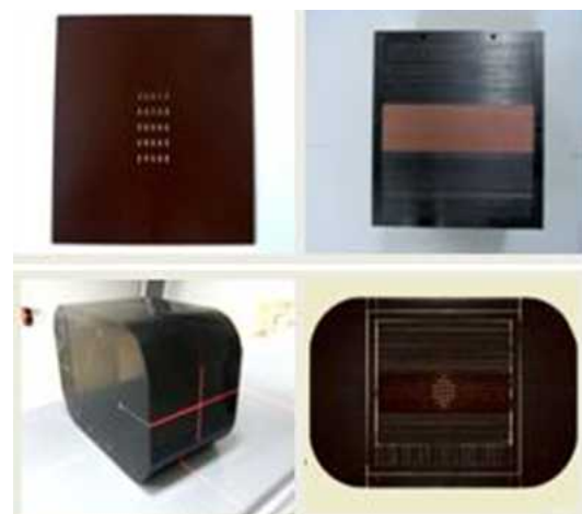
図2 作成した水等価性ファントムシード線源が留置できるように加工した。
