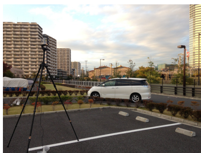
図12 LiDARによる車両認識・制御の様子
