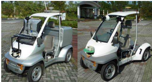
図5 自走可能な遠隔操縦装置搭載車両(左)と被遠隔操縦車両(右)
