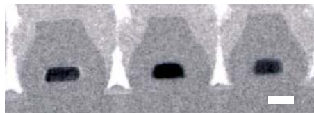
図7 初期幅 40～60nm のシリコンナノ構造酸窒化の TEM 結果（白いスケール：25nm）
