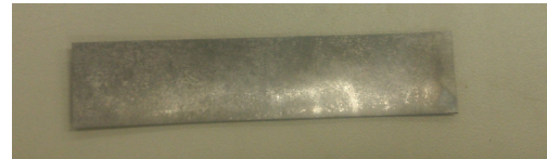
図 1：製作した IPMC アクチュエータ（長さ 40mm × 幅 10mm × 厚さ 0.2mm）
