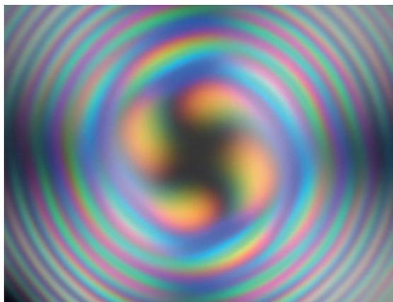
図10. 右水晶板の上に左水晶板を重ねたときのコノスコープ像
