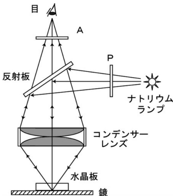
図24. エアリースパイラル測定装置の原型 (PとAは直線偏光板)<sup>12)</sup>
