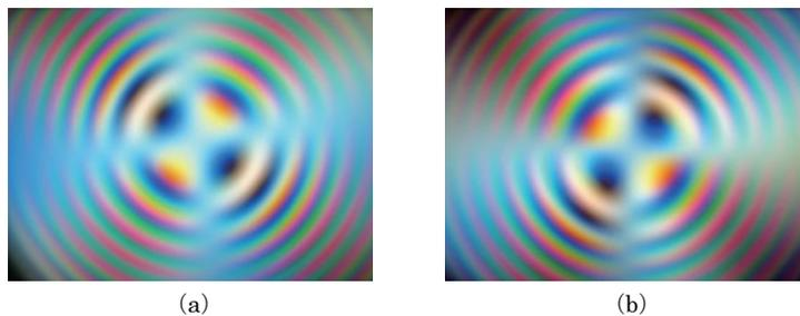
図20. サファイア板（厚さ 4 mm）のコノスコープ像。検光子として (a) 左円偏光板，(b) 右円偏光板を使用（ただし偏光子の透過軸は水平方向）
