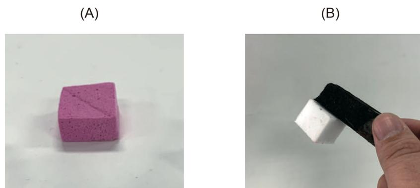
図6.23: 異なる機能性インクを染み込ませた FoamSense, (A) ロイコ染料を染み込ませた FoamSense, (B) フェライトを染み込ませた FoamSense(黒色), 表面にネオジウム磁石を固定したスポンジ (白色)
