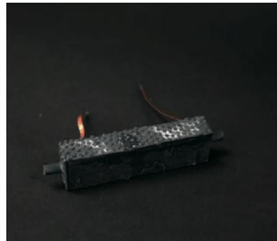
図8.9: 様々な形状のポンプの試作品 (A) 曲面構造をもつポンプ, (B) ブロック型のポンプ, (C) 円柱型ポンプ, (D) ゴム材料で形成される曲げられるポンプ (Formlabs, flexible フィラメントにより作成)
