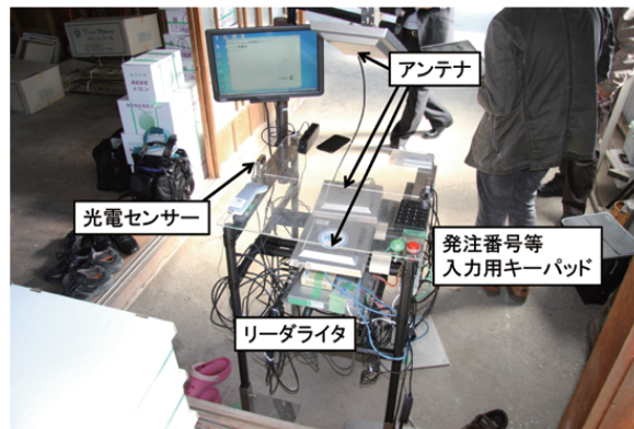
図 3.8 EPCIS showcase プロジェクトで構築した据え置き式キャプチャ装置
