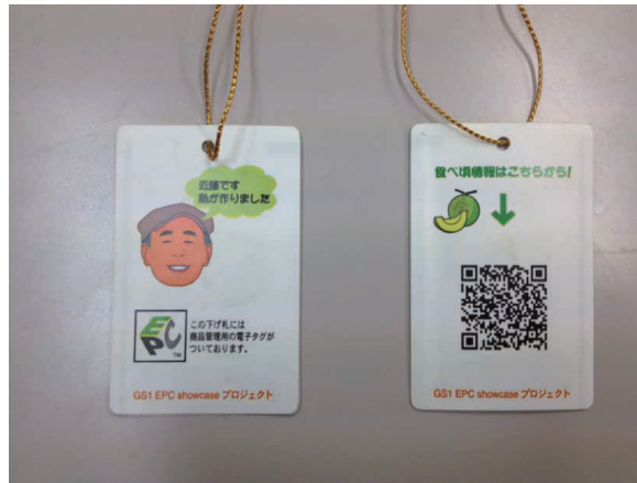
図 3.7 EPCIS showcase プロジェクトで用いた RF タグ内蔵下げ札
