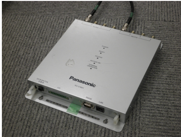
図 4.14 グループ符号化実装に用いた UHF 帯 RFID リーダライタ KU-U1601
