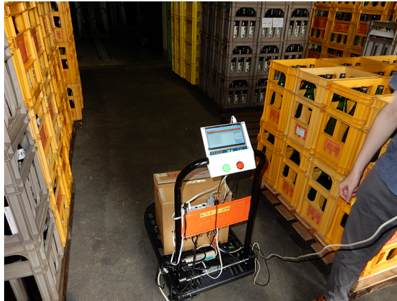
図 3.16 EPCIS showcase 日本酒物流可視化で構築した RFID 読み取り台車
