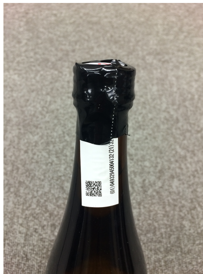
図 3.15 EPCIS showcase 日本酒物流可視化で用いた開栓検知 RF タグ
