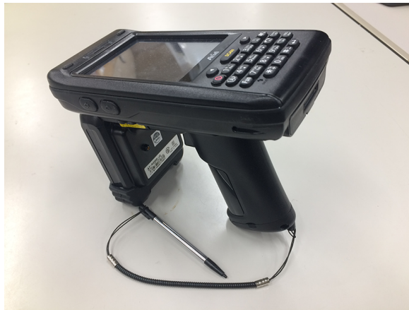
図 3.18 ふくろい e ねっとで用いた携帯式 RFID・バーコード読み取り端末
