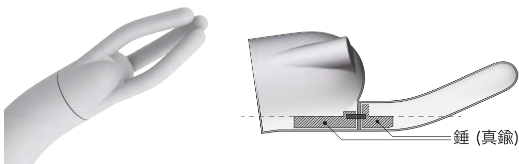
図3.8: ハンド部分の構造
