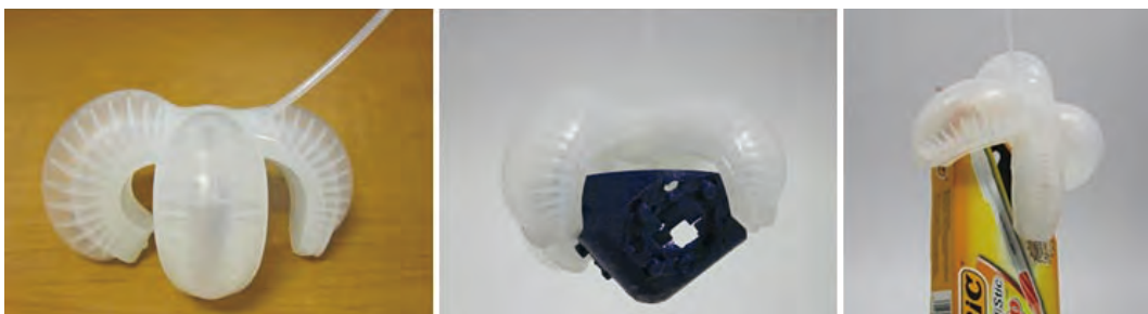
図 2.7: Ilievski によるシリコンラバー製のグripper
