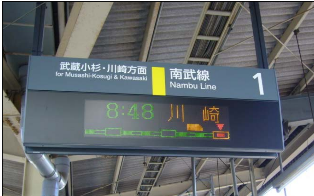
図 4-11 開発した列車在線位置表示
