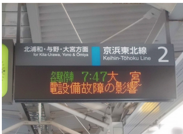
図 4-5 LED による輸送障害表示例
