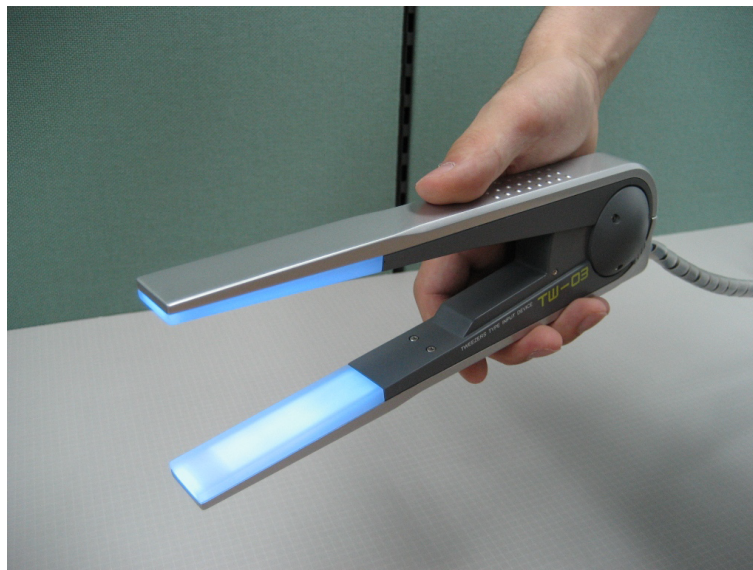
図 4.4: 空間型作業での選択・移動操作に適した道具型デバイス
