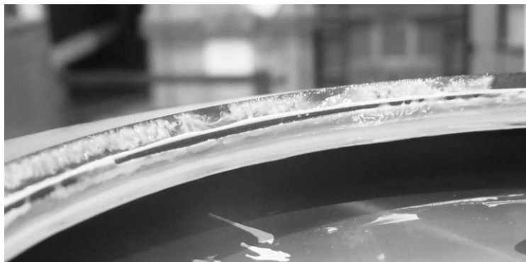
図 3.3.20 耐久試験200時間後のオイルシール大リップ表面
