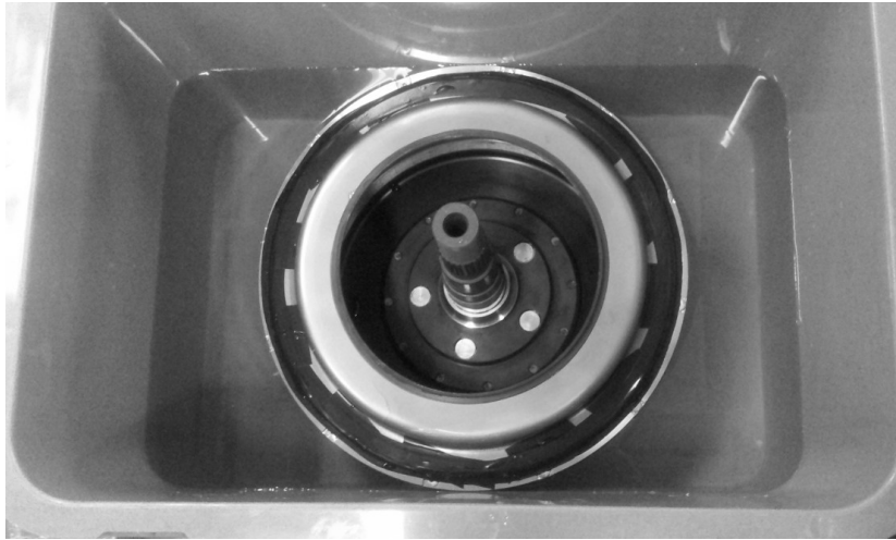
図 5.8.29 水没試験前の確認の様子
