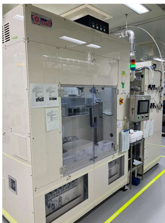
図 2.9 枚葉式洗浄装置 (MTK 製 CL43D105)。手前に見える開閉部内にウエハカセットをセットし、洗浄を行う。奥に見えるキャビネットから薬液が供給される。
