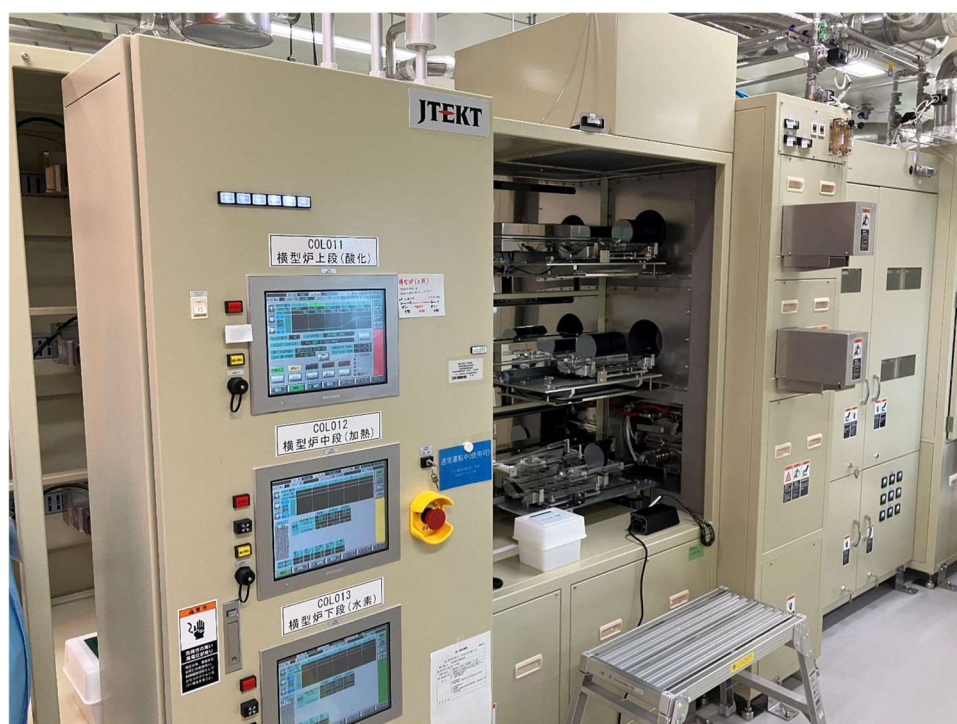
図 2.11 横型炉（ジェイテクトサーモシステム製 280A-M300）。上段が酸化炉、中段が加熱炉、下段が水素アニール炉。中央に見える石英ボートにウエハをセットし処理を行う。
