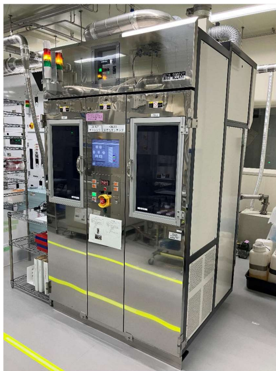
図 2.17 アッシング・等方性エッチング装置（キャノンマーケティングジャパン製 MAS-8220AT）。左右の取り出し口にウエハカセットをセットし、枚葉で処理を行う。
