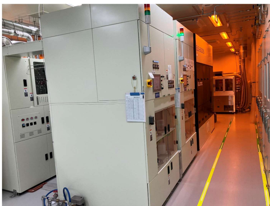
図 2.13 熱 CVD 装置（ジェイテクトサーモシステム製 VF-3000LP）。手前が窒化膜成膜用、奥が poly-Si 成膜用。装置前面中央にウエハカセットをセットし、装置内ボートに搬送し、バッチで処理を行う。
