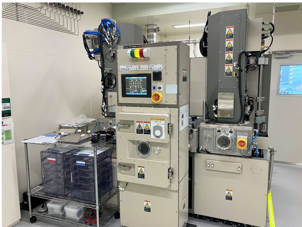
図 2.15 スパッタ装置（キャノンアネルバ製 EC7001）。左に見えるウエハトレイに 3 枚ずつウエハをセットし、装置前面中央のチャンバーにセット、トレイごと搬送し、処理を行う。
