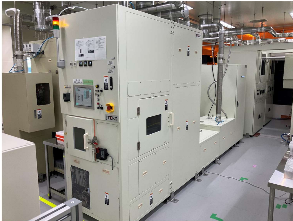
図 2.12 急速熱処理装置（ジェイテクトサーモシステム製 RLA-3104-V）。装置前面中段の取り出し口にウェハカセットをセットし、枚葉で処理を行う。
