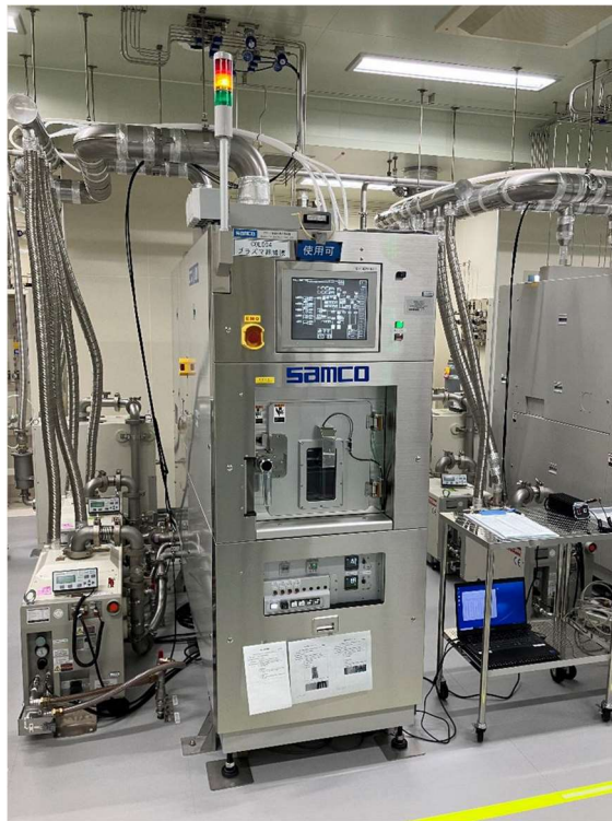
図 2.14 プラズマ CVD 装置（サムコ製 PD-2201LC）。装置前面の中央段の取り出し口にウエハカセットをセットし、枚葉で処理を行う。
