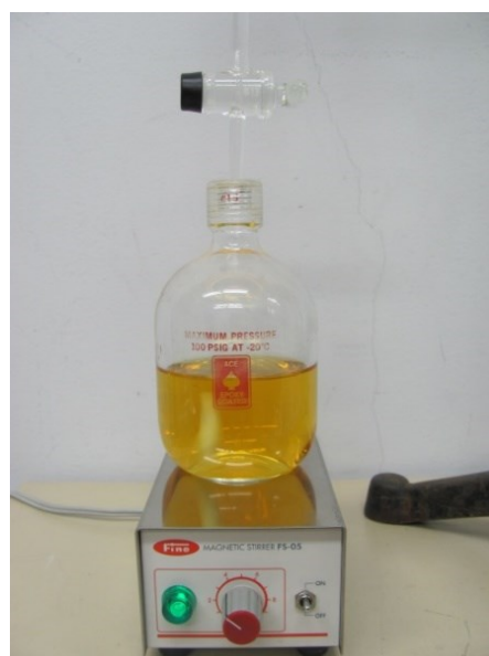
(a) ヨウ化カリウム水溶液と O_3 との反応 (b) チオ硫酸ナトリウム水溶液で溶液の色が変化
