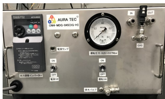
図 4.2 マイクロ・ナノバブル発生装置 (OM4-MDG-045 (OG-H); 株式会社オーラテック)
