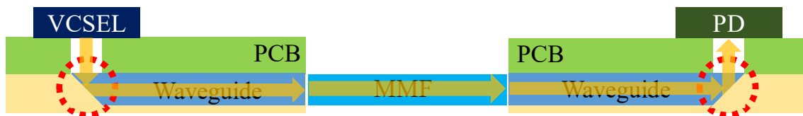
Fig. 2-11 45° ミラーによる直角光路変換型光リンク
