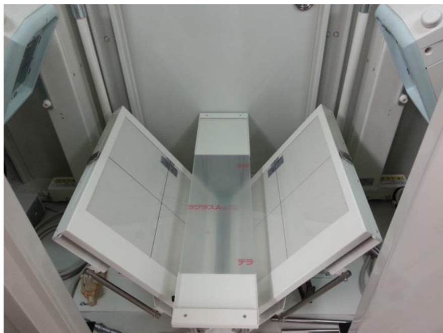
図 2-2 2 方向 X 線透視システムの構成 (上) と外観 (下)
