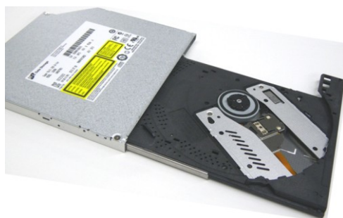
(c) ウルトラスリム型 (装置高さ 9.5 mm)
