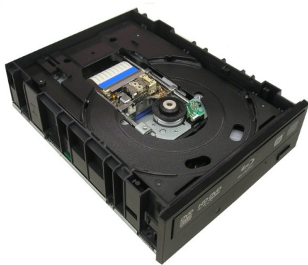
(a) ハーフハイト型 (装置高さ 41 mm)
