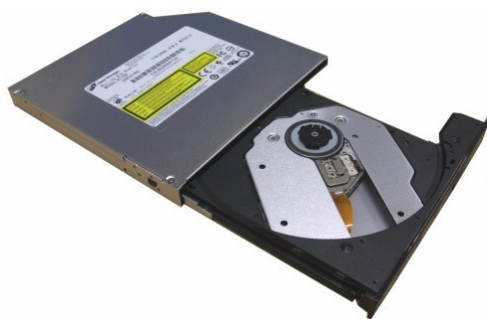
(b) スリム型 (装置高さ 12.7 mm)
