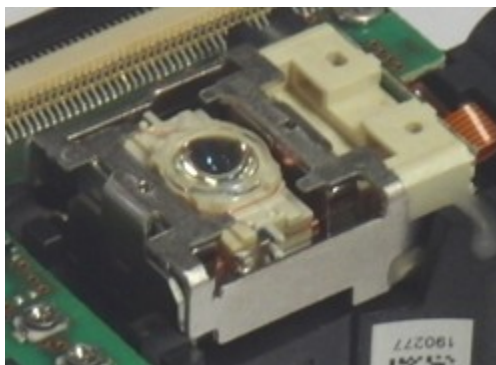
図 5.23 作製した DVD 用ハーフハイト型対物レンズアクチュエータの外観
