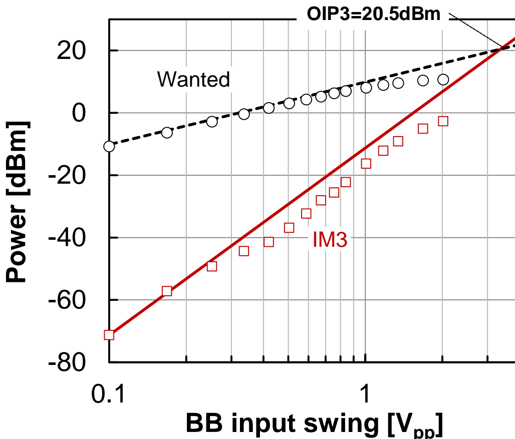
図 3-26 開発した LTE バンド 1 用送信回路の 3 次歪み測定結果
