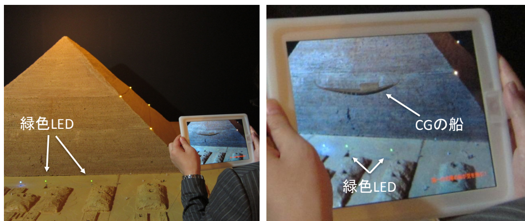
図 2-10 : LED をマーカーとして利用する拡張現実ガイダンスサービスシステム運用例
