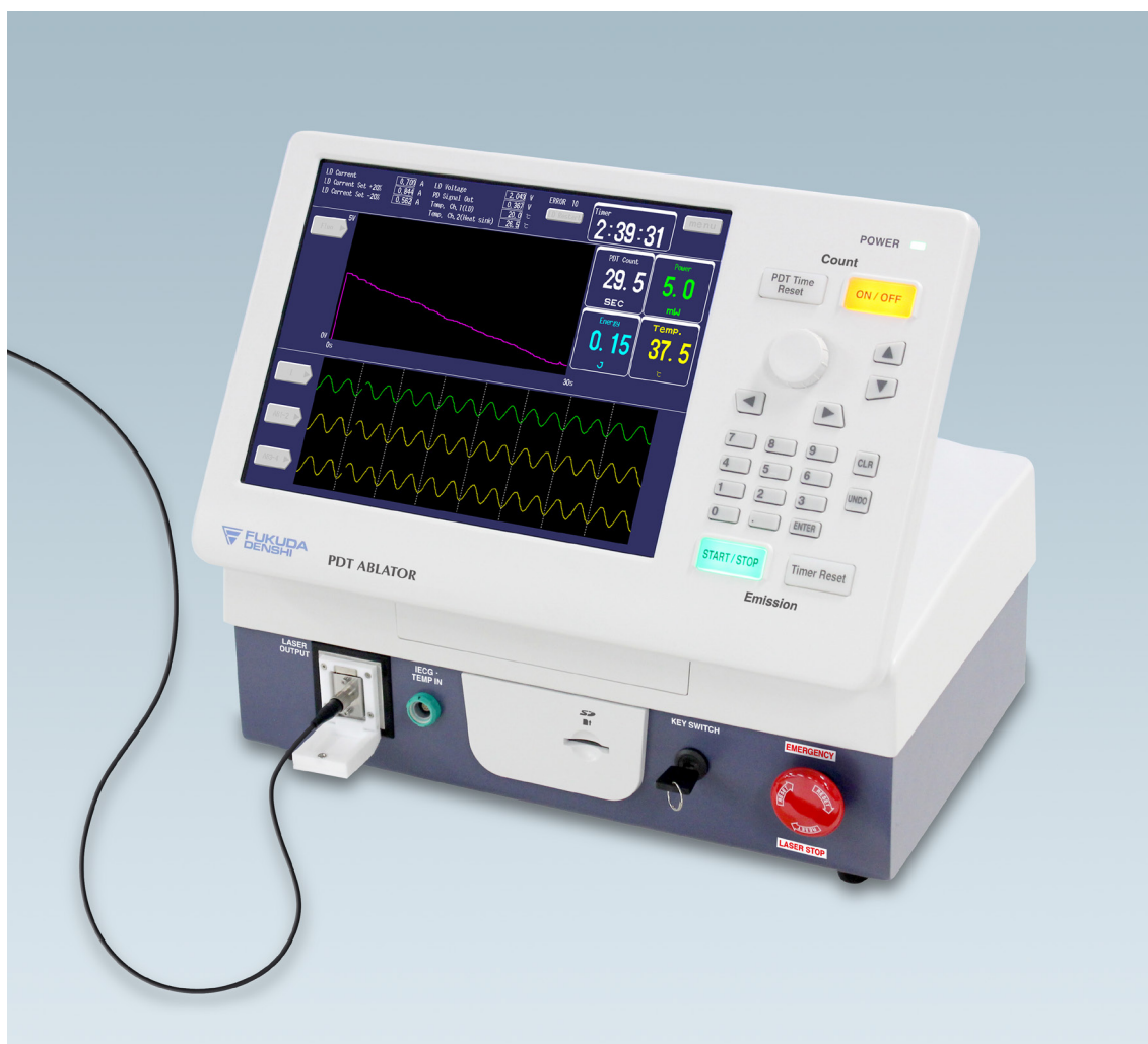
図 4-11 レーザ発振装置、モニター装置、およびカテーテル先端電位表示機能を備えた一体型の光線力学アブレーション装置の外観 (文献 [22]より引用改変)
