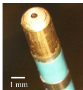
図 5-2 経レーザーカテーテル的にブタ心内腔にて放射照度 40 \text{ W/cm}^2 にて光線力学アブレーションを行ったときにレーザーカテーテル先端光学窓に付着した血液の炭化物
