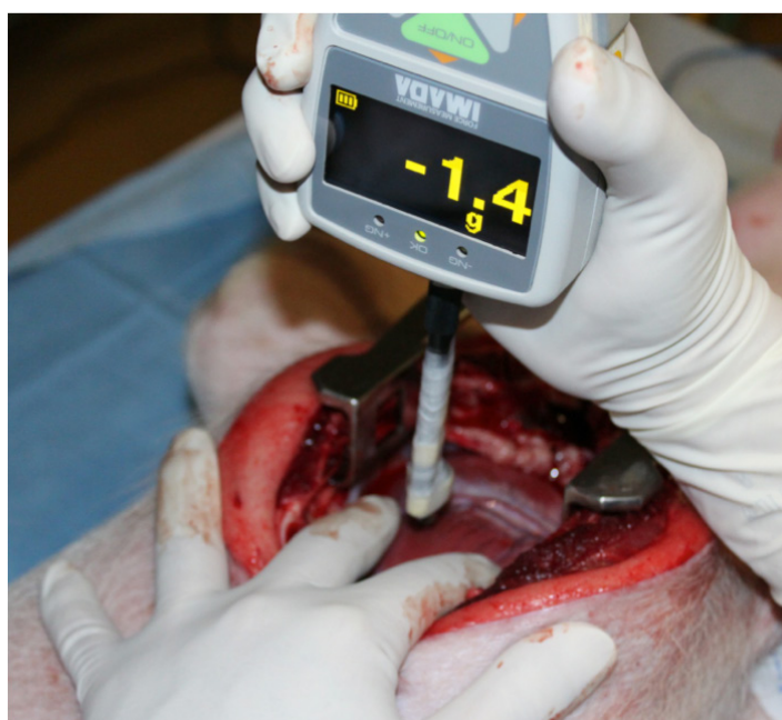
図 7-17 デジタルフォースゲージを装着したレーザドップラー血流計を用いたブタ開胸下心筋における血流速計測
