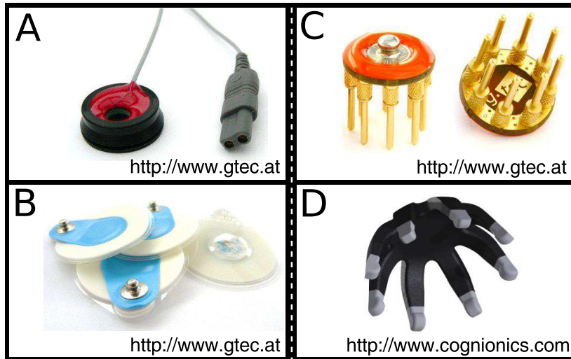
図 1.3 湿式電極と乾式電極
