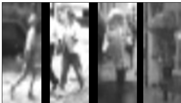
図 3.13 ECoHOG や PCA-ECoHOG への改善で検出できた Daimler pedestrian benchmark dataset の画像例：CoHOG では姿勢変動した場合や人によってオクルージョンが発生している場合，複雑な背景状況，傘など物体によって人物形状の一部が変更されている場合などに未検出であった．
