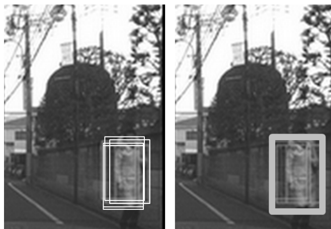
図 2.7 階層的クラスタリングによる検出枠の統合：(左) ラスタスキャンによる人物検出では人物領域周辺に複数の検出枠が配置される (右) 階層的クラスタリングによる検出枠の統合，ユークリッド距離を指標として近傍の枠を統合する
