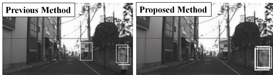
図 4.19 路上データセットでの検出例：(左)CoHOG での検出．過検出が背景に出力されている上に人物を検出できていないため未検出となっている．(右)ECoHOG での検出．過検出がなく，人物領域周辺に複数の検出枠が配置されている．
