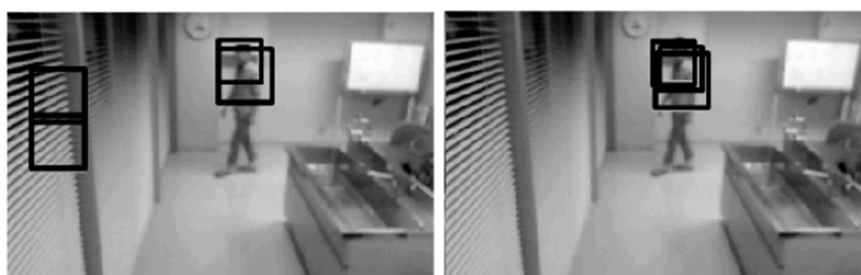
図 4.20 監視カメラ映像での検出例：(左)CoHOG での検出．未検出はなく，人物領域周辺に複数の検出枠が出力されているが，過検出を含んでいる．(右)ECoHOG での検出．人物領域上に多数の検出枠が出力されている．
