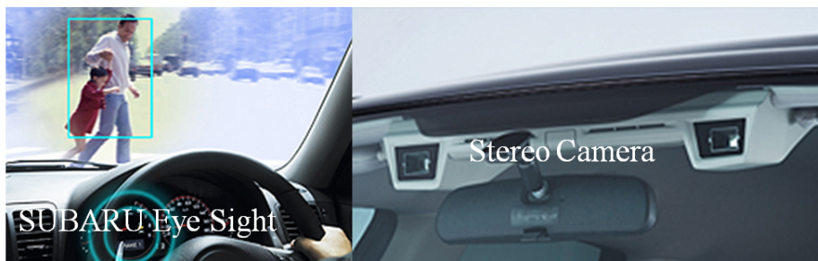
図 4.3 SUBARU Eye Sight ® : 屋内のリアカメラの上部に取り付けたカメラにより車両の前方を撮影して歩行者や障害物を捉える．Eye Sight では歩行者の衝突回避機能だけでなく，車線逸脱の防止や前方車両の自動追尾機能も搭載する．
