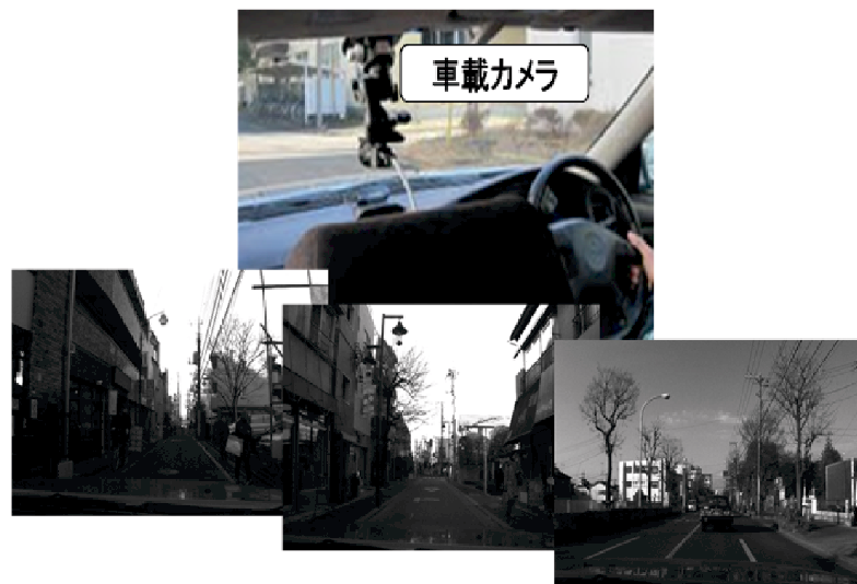
図 4.15 カメラ位置と撮影された画像：車載カメラはルームミラーの上部に取り付け前方を撮影する。
