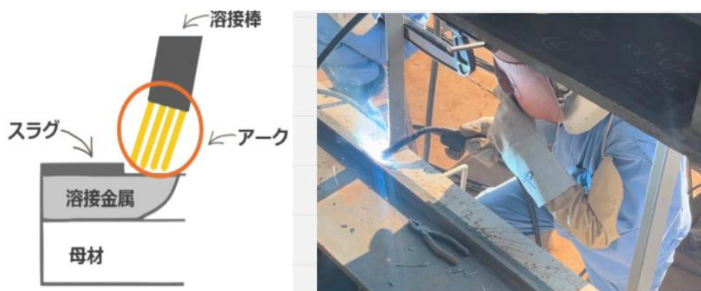
図 13：溶接イメージ（左）、実際の溶接作業（右）
