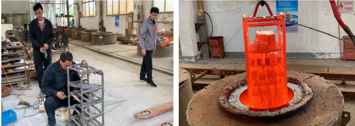
図7 棚を造る様子と TD 処理 (出典：著者による撮影)
