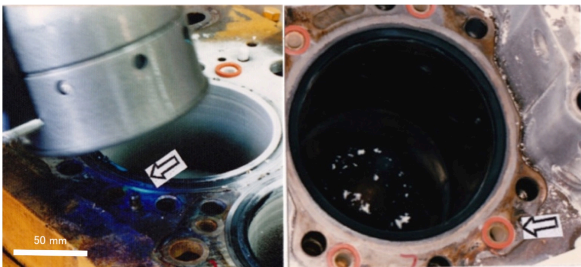
図 3-2-13 台上エンジン試験における冷却水漏れ直後の水シール周りの状況 (左写真:紫外線により青く光る不凍液、右写真:水シールの状態)
