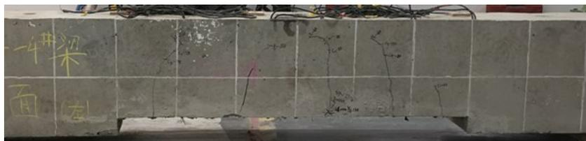
(d) Crack pattern of Case 4 after testing
