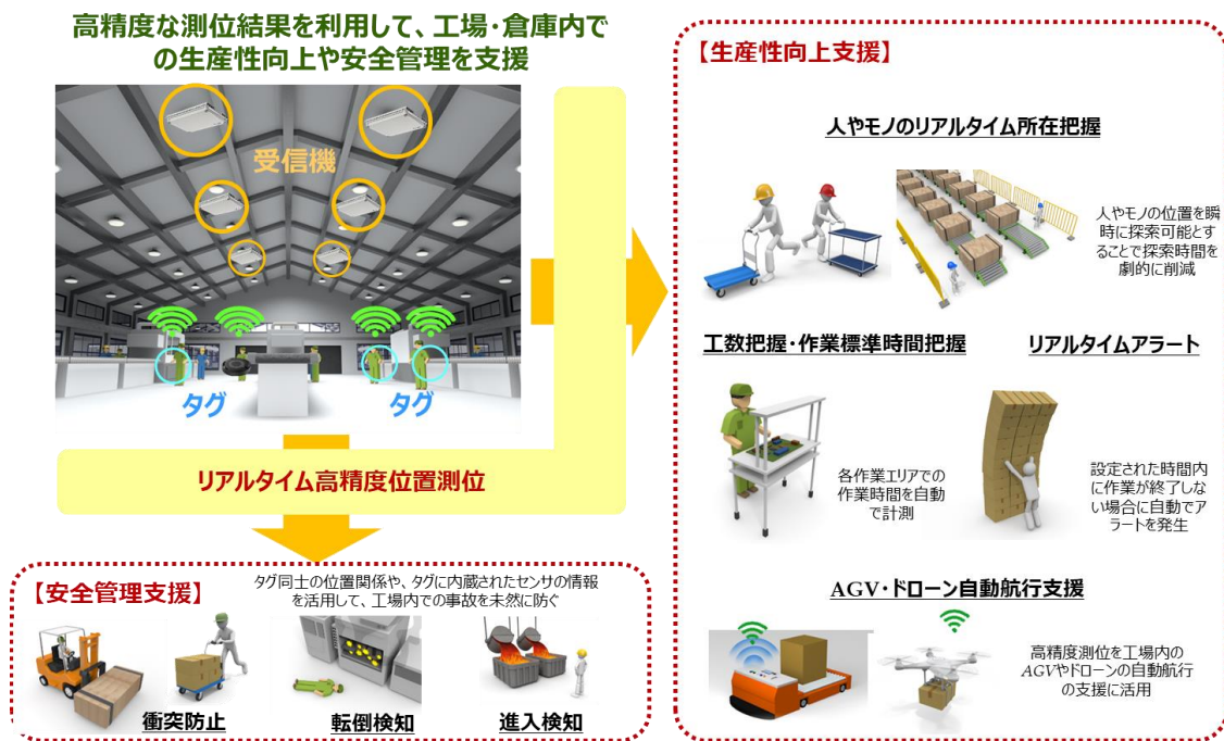
図 3-4. 工場や倉庫におけるシームレス測位システムの利用用途
