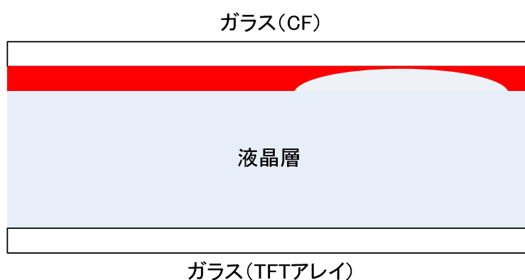
Fig. 4-19: 欠陥画素（カラーフィルタ）の液晶層への影響
