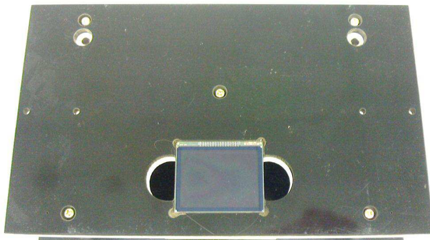
Fig. 3-15: Cell-E Test 用の測定治具に載った液晶パネル
