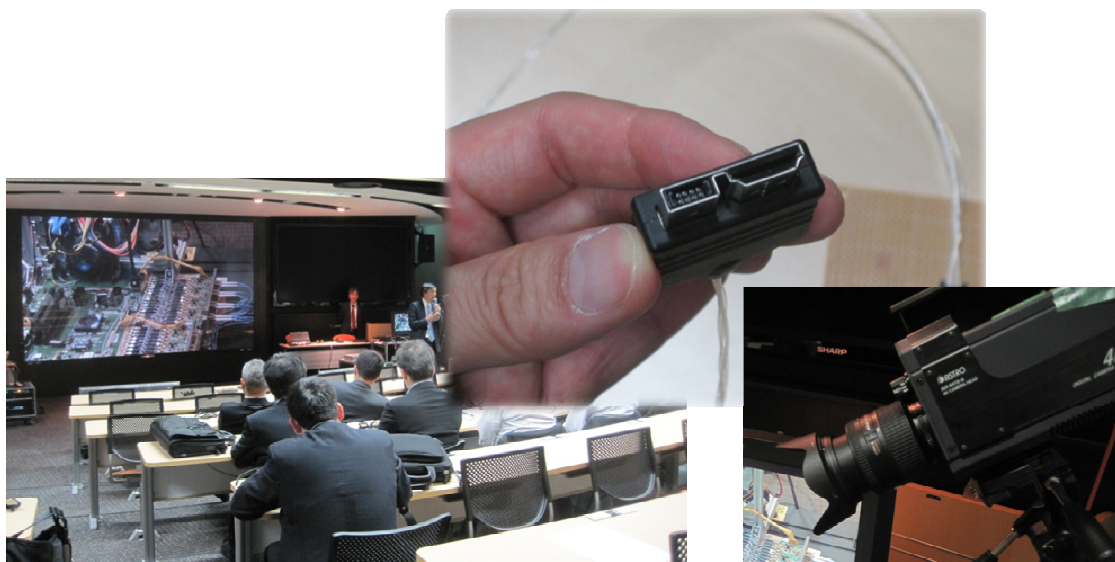
図 3-11 光電ハイブリッドコネクタに4K3D映像が流れたことを確認
