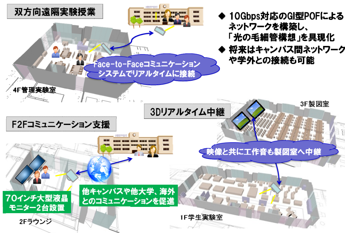
図 6-2 10 ギガネットワークを活用した 34 棟内部のシステム事例
