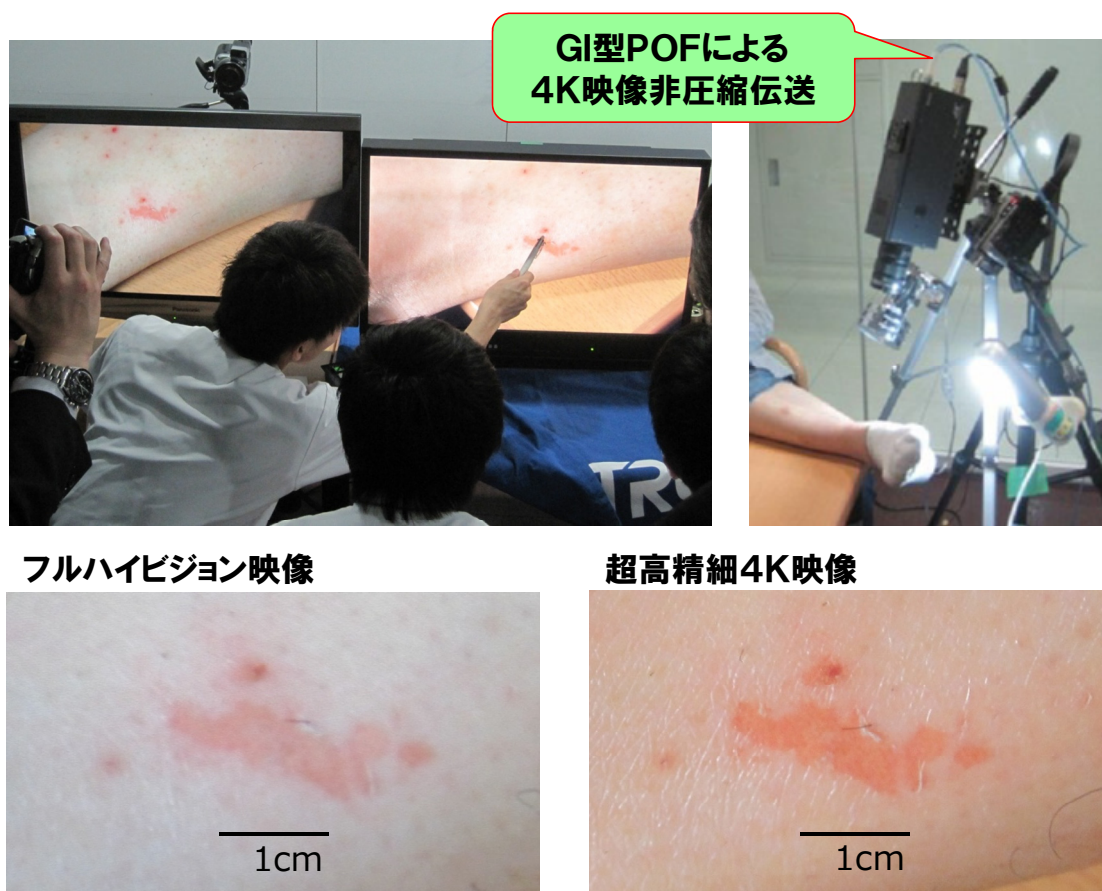
図 5-7 4K 実験の様子と撮影した映像例(患者 C のふくらはぎの傷)
