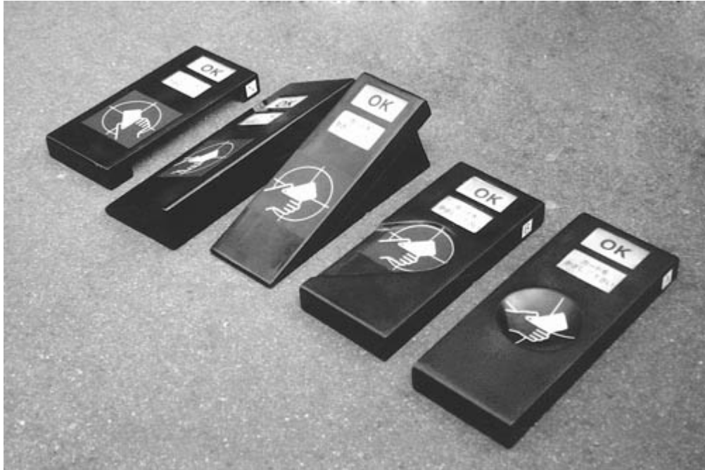
図 4 SUICA のタッチ式読み取り機のプロトタイプたち。「手前に少し傾いている光るアンテナ面」が人の動作を誘発することを発見した。[15]。
