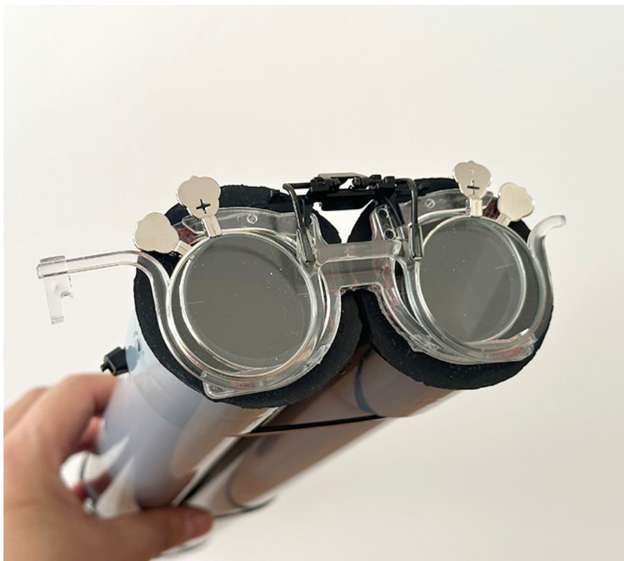
図 5-2. 光学レンズを採用（プリズムレンズと凸レンズ）
