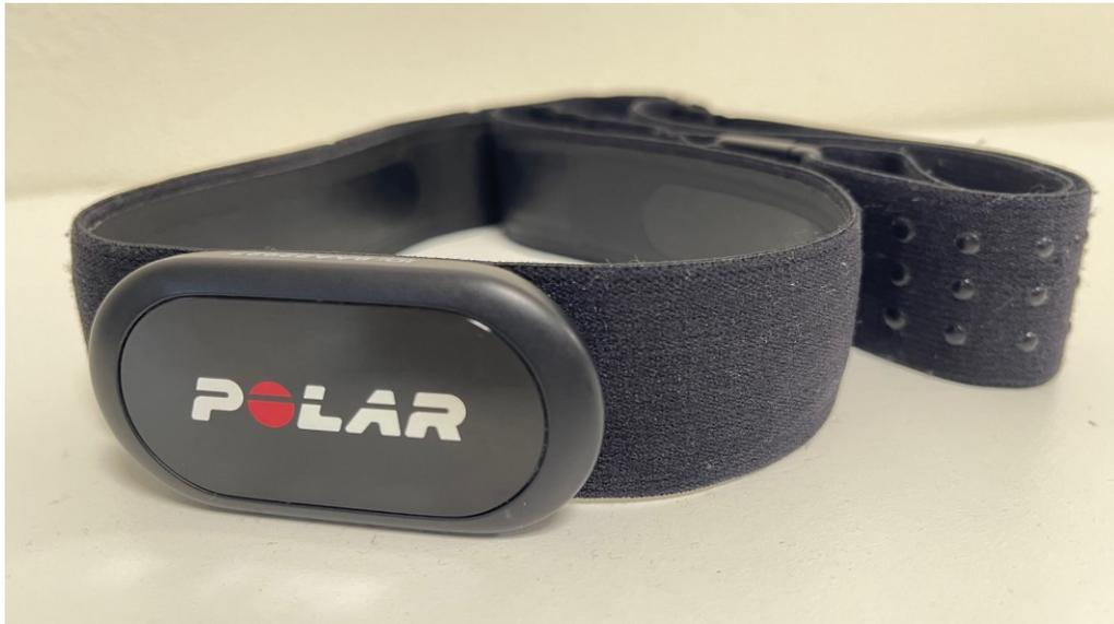
図 2-5 心電計測器 POLAR-H10
