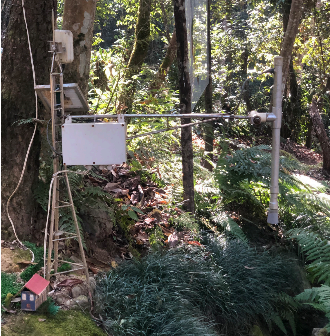
図 B- 3. 超音波方式水位計測装置と Data Acquisition Unit (太陽パネル付き)
