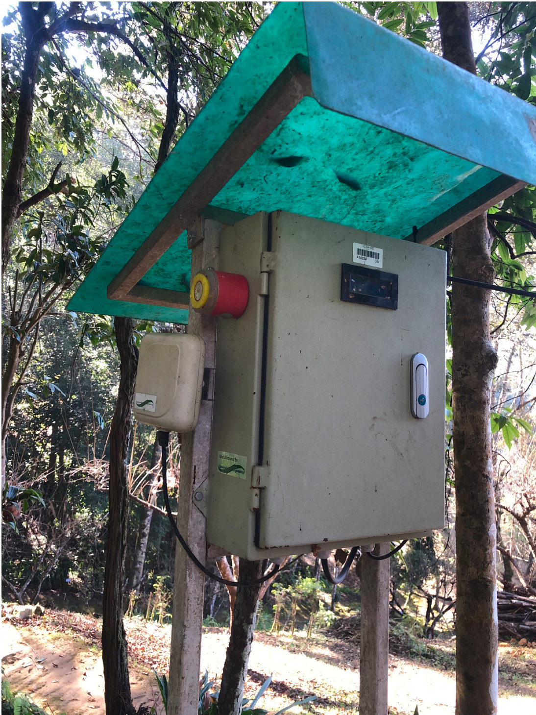
図 B- 6. Data Upload Unit (アラーム付き) (別装備形態)
