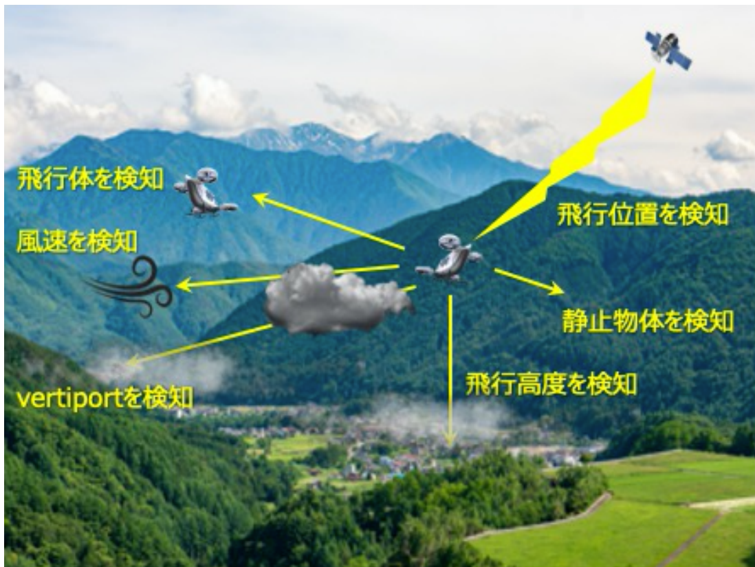
図 4-4 新千歳空港-ニセコ間飛行のシステム概念図
