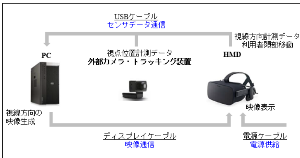
図 3-3 従来の PC 型 HMD の通信
