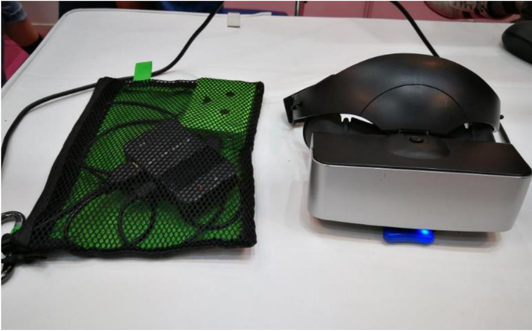
図 3-11 ワイヤレス化 HMD のプロトタイプ
