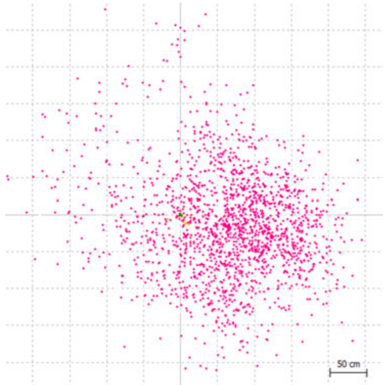
図 遮蔽環境(傾斜地)における測位結果(静止)
