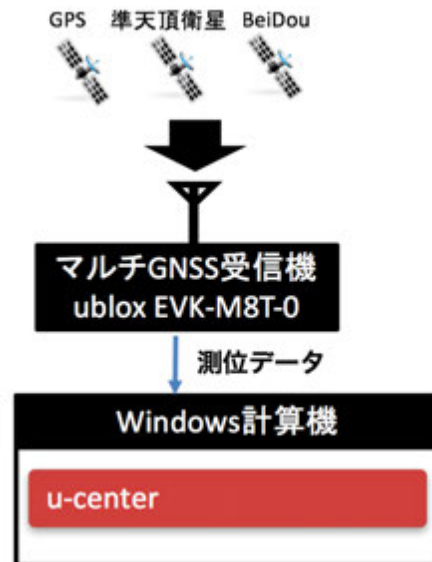
図 4-2 衛星測位検証のためのシステム構成(1台あたり)
