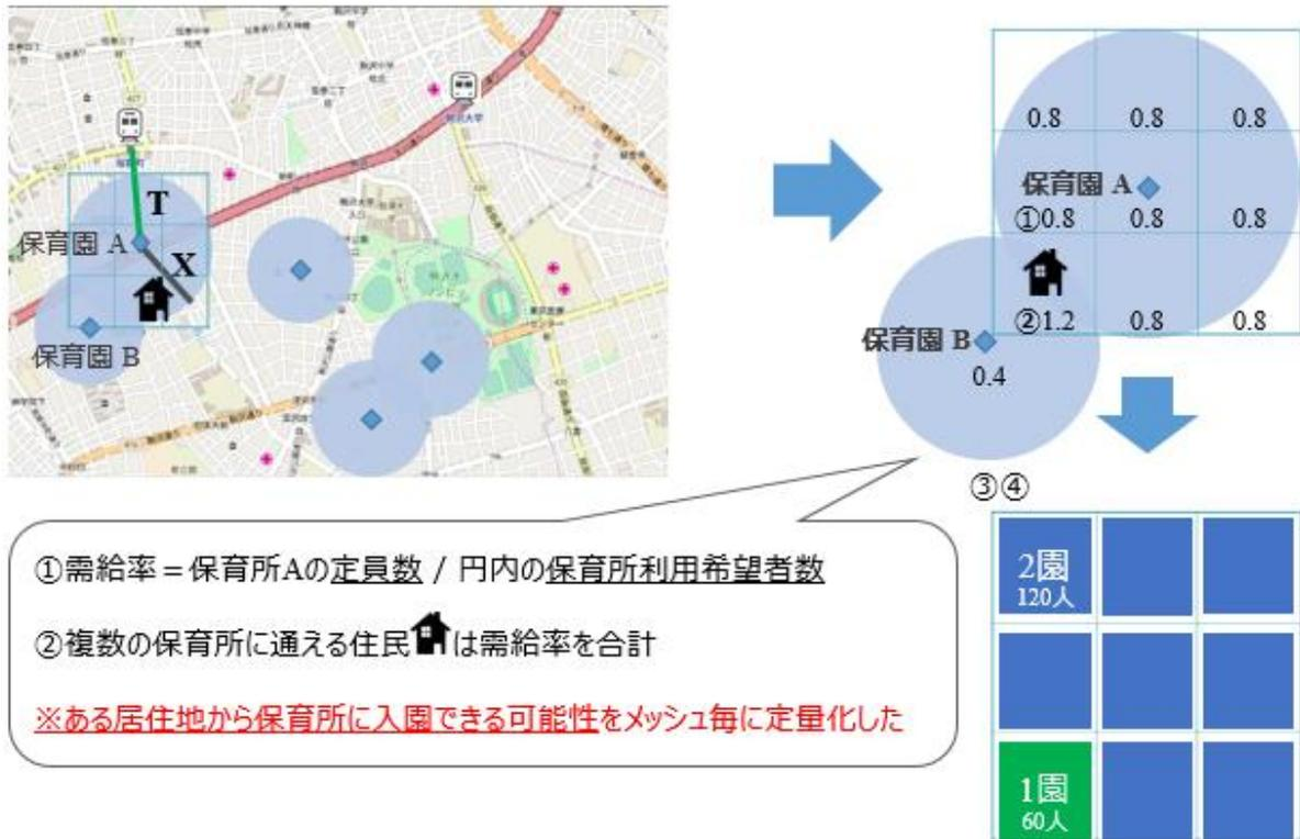
図 29 本手法の設計プロセス（保育所需給率）
