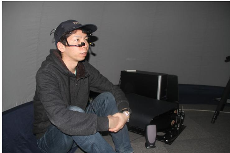
図 6-9：視線計測装置を装着した被験者
