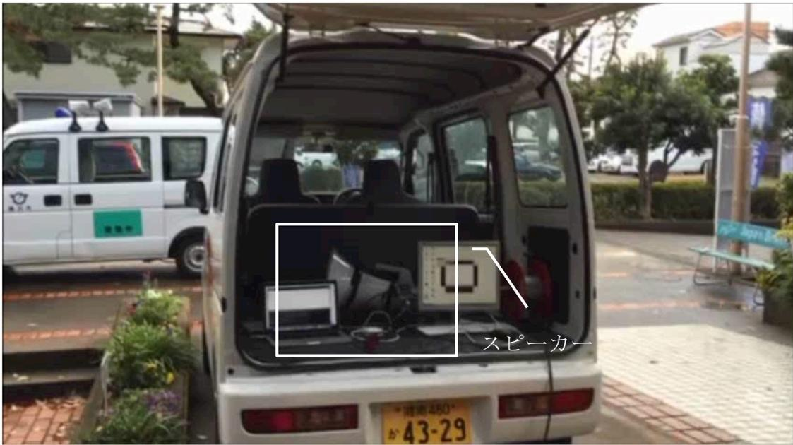
図 22 車両の後部スペースに設置したスピーカー
