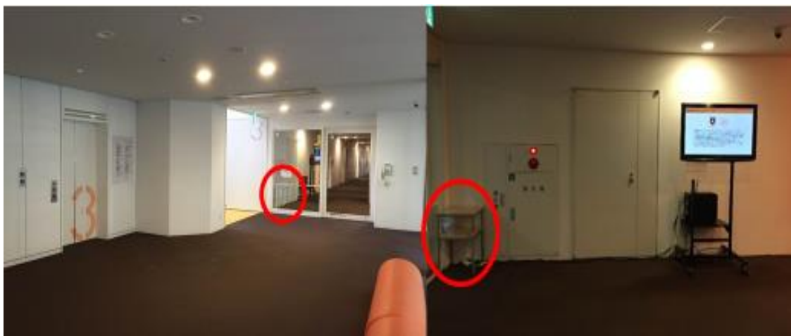
図 21 自動的にアクセスポイントが切り替わるルータの設置場所
