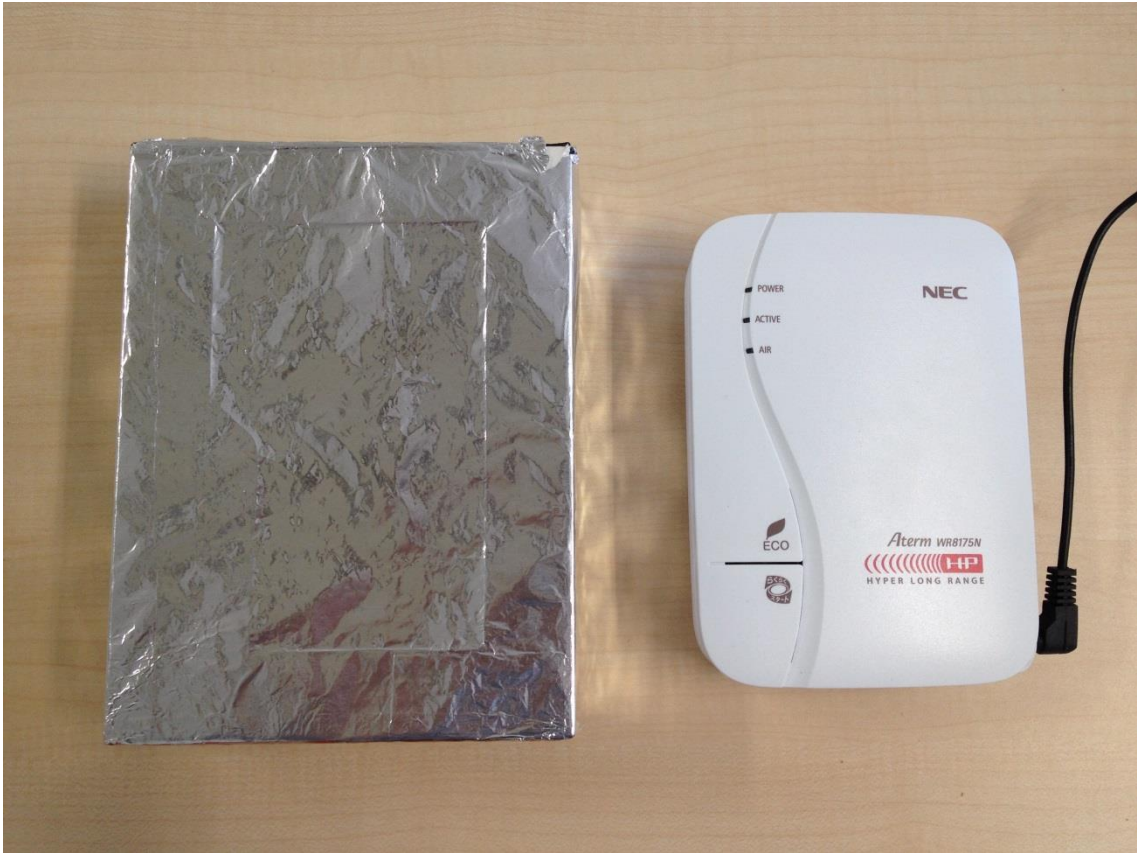
図 24 アルミによる Wi-Fi ルータの遮蔽
